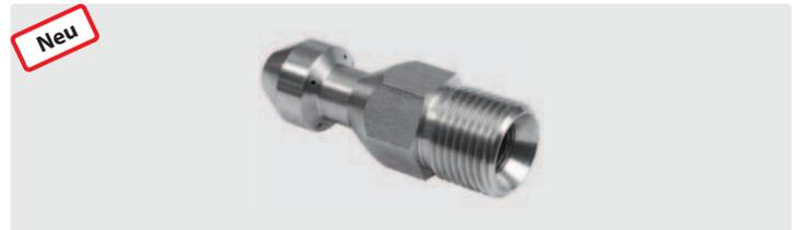
Rohrreinigungsdüse für Standard-Anwendungen. 4 Bohrungen hinten (30°) für gute Zugwirkung. Konische Spitze für enge Rohrbögen und Vorsprünge.
